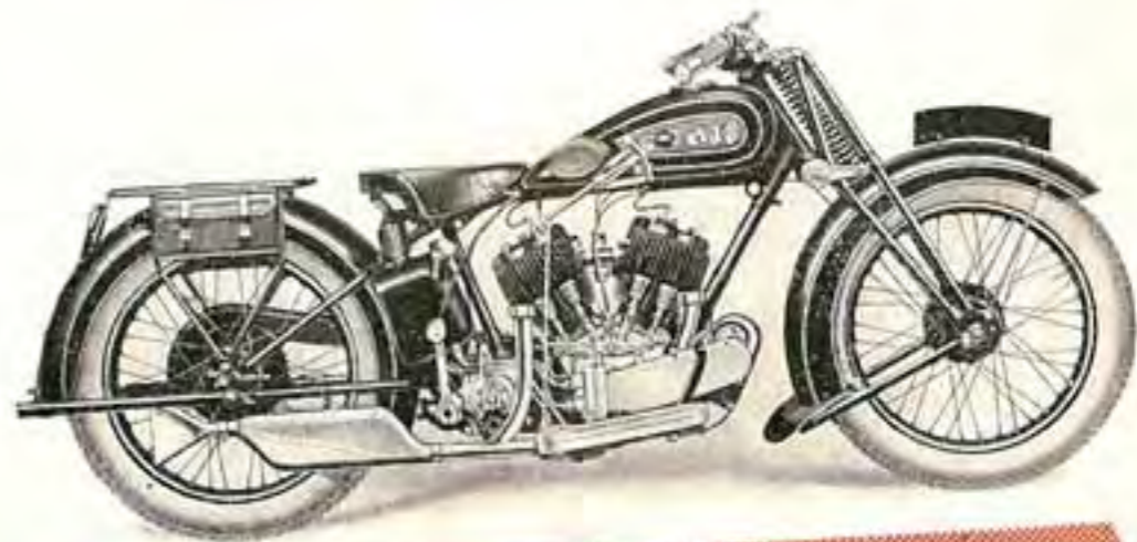
La 1000 A.J.S. Tourisme Standard Soupapes latérales. — Modèle M. 2.
