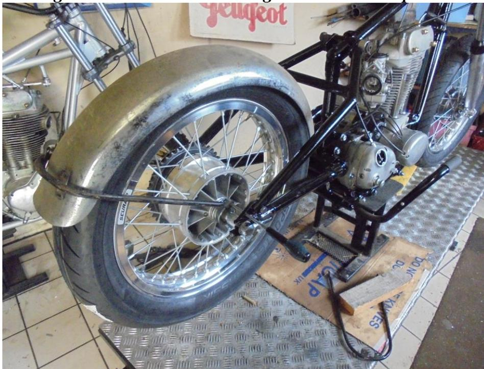
*Présentation du tube d'échappement avant ajustage de sa forme.*
