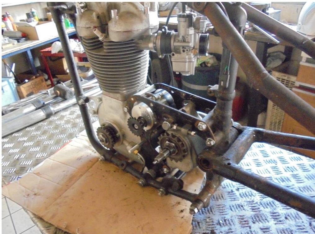
*Ainsi, la transmission a pu être remontée avec son carter primaire intérieur, son embrayage type AMC et les chaînes de transmission primaire et d'alternateur – A noter que la tension de la chaîne primaire s'opère par déplacement de la boîte dans ses platines, et la tension de la chaîne d'alternateur s'opère par rotation de celui-ci dans son logement, avant blocage.*
