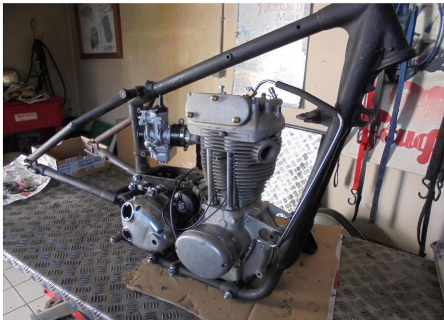
*Montage du carbu Dell'Orto PMH32 (à pompe de reprise) et de la canalisation d'huile vers la culasse.*
