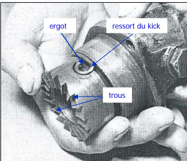
Insérer l'axe de kick (BK14) dans le carter en positionnant un des ergots du rochet dans la boucle du ressort de kick
