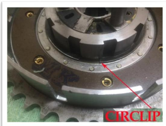
Dans notre cas nous aurons une couronne simple, **Part Number 27535 CLUTCH SPROCKET/DRUM, 42T WITH BEARINGS** pour une chaîne simple de transmission primaire qui a été fabriquée jusqu'en 1956 pour la 350cc Clipper (Model G de Luxe). A partir de cette année, les modèles J et J2 ainsi que le Modèle G ne se fabriqueront plus et feront de la place aux modèles Bullet 350 et 500 cc, avec une transmission primaire
