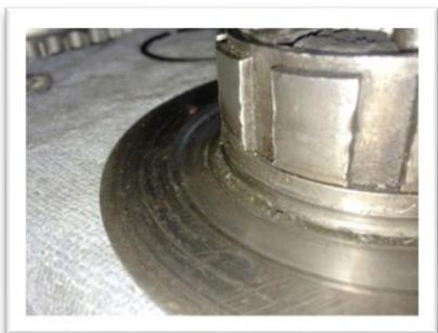
D'une part une oscillation de l'ensemble des disques qui provoquera quelques points de friction contre la plaque de pression quand elle est en train de s'écarter et ce qui se traduira par un contact imprécis de l'embrayage.
