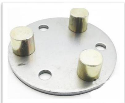
La plaque de support des ressorts (G79), tant le vieux modèle (avec une forme de capuchon), comme le plus moderne, (image), avec 3 butoirs où le disque de pression repose quand on embraye et en même temps comme rail des 3 ressorts dans le cas d'être installé comme option. Il faut régler l'embrayage pour qu'à la fin de son parcours la plaque de pression repose complètement à plat contre son butoir une fois embrayé. Ses 3 vis doivent se visser à
