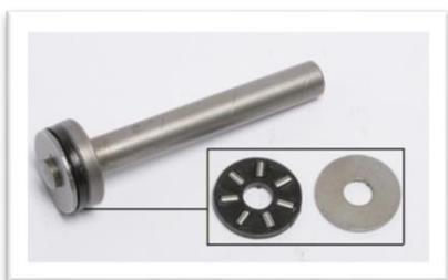
Vraiment, si nous y réfléchissons et comparons le système utilisé par Albion pour pousser la plaque de pression avec d'autres systèmes tels que Sanglas, Ducati ou Norton, dans lesquels l'extrémité de la tige est insérée dans un tube qui l'oblige, dans un espace qui l'empêche son déplacement latéral, de se centrer pour pousser parfaitement alignée, moyennant une
