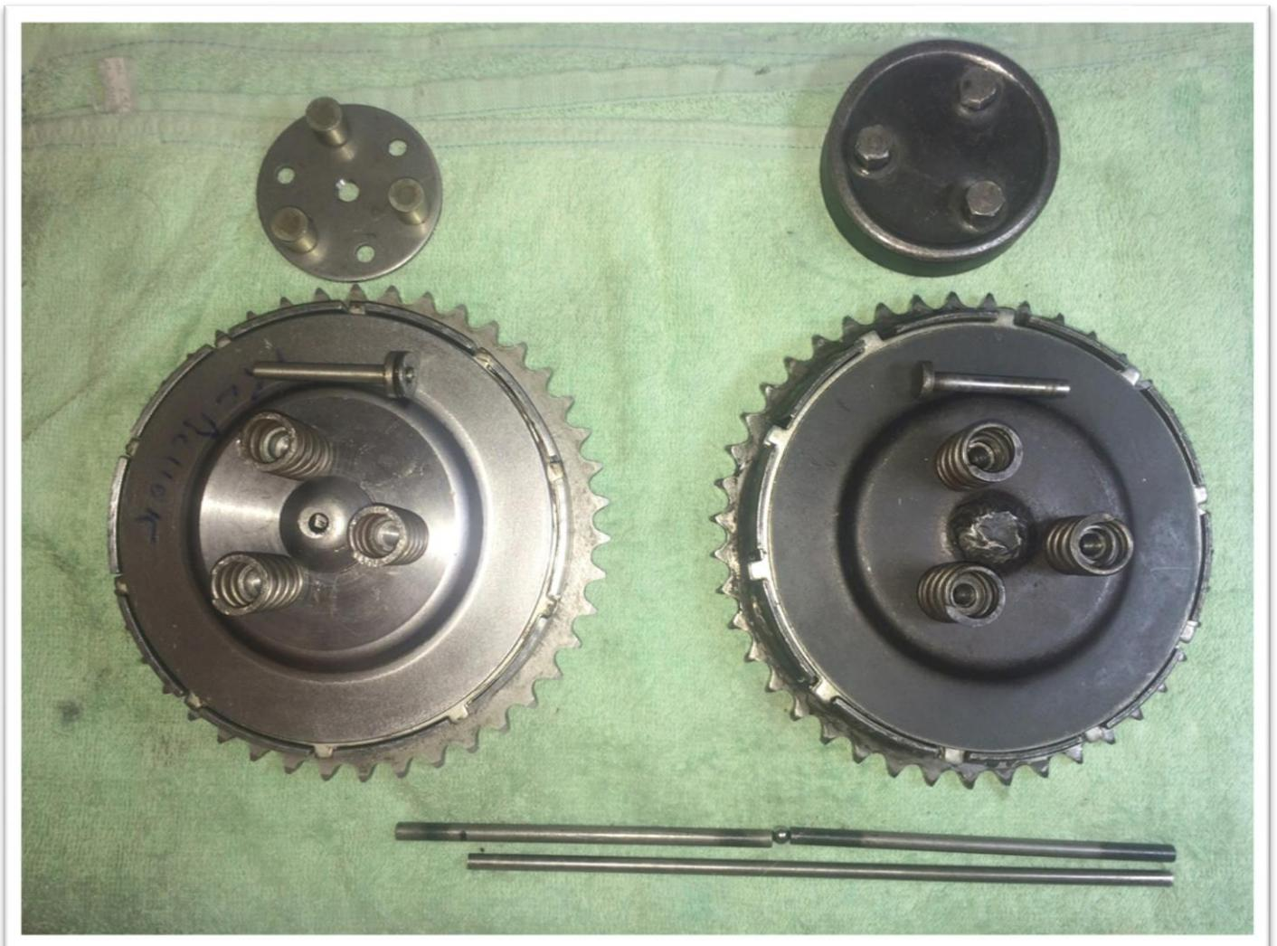
*A gauche le neuf embrayage SAMRAT et a droit le vieux embrayage avec une couronne avec plaquettes en liège, bricolé et modernise avec des disques de friction de matériaux de friction fritté.*
