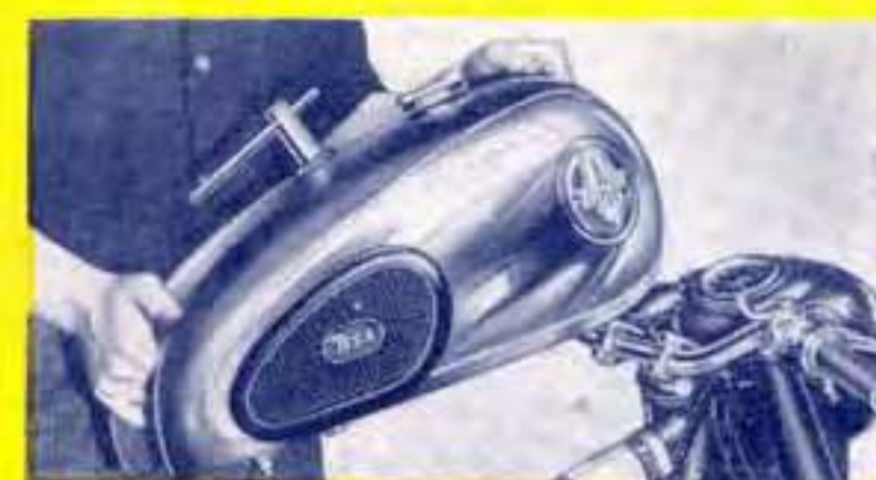
Réservoir d'essence avec panneaux chromées, monté sur caoutchouc 100%, et fixé par un seul boulon pour permettre l'accès facile au moteur. Sur les modèles A et B.
