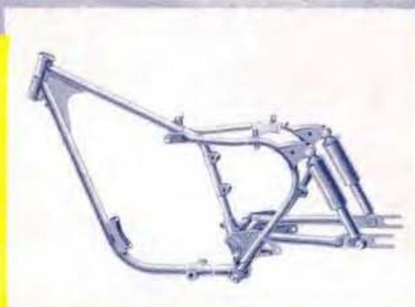
Nouvelle suspension arrière à bras oscillant avec amortisseurs hydrauliques et silent-blocs, assurant confort, tenue de route et stabilité. Sur modèles "Princess"
