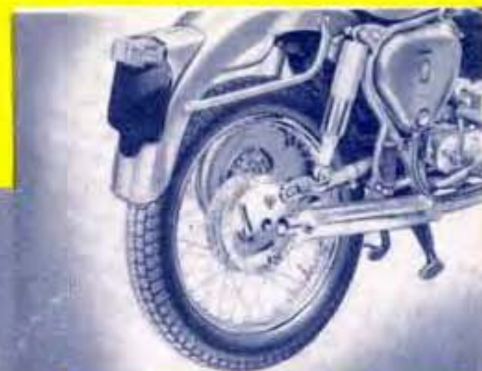
Roue arrière rapidement démontable. Sur les modèles A et B (figure) et M33.
