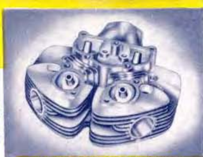
Culasse en alliage d'aluminium à grand rendement. Sur les modèles A7 Shooting Star et A10 Road Rocket.
