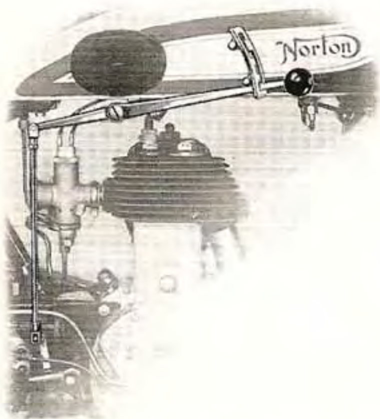
La nouvelle commande des vitesses et son dispositif de fixation.
