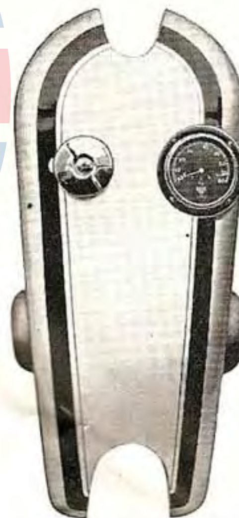
Réservoir Norton montrant un compteur kilométrique qui peut être obtenu moyennant un supplément.
