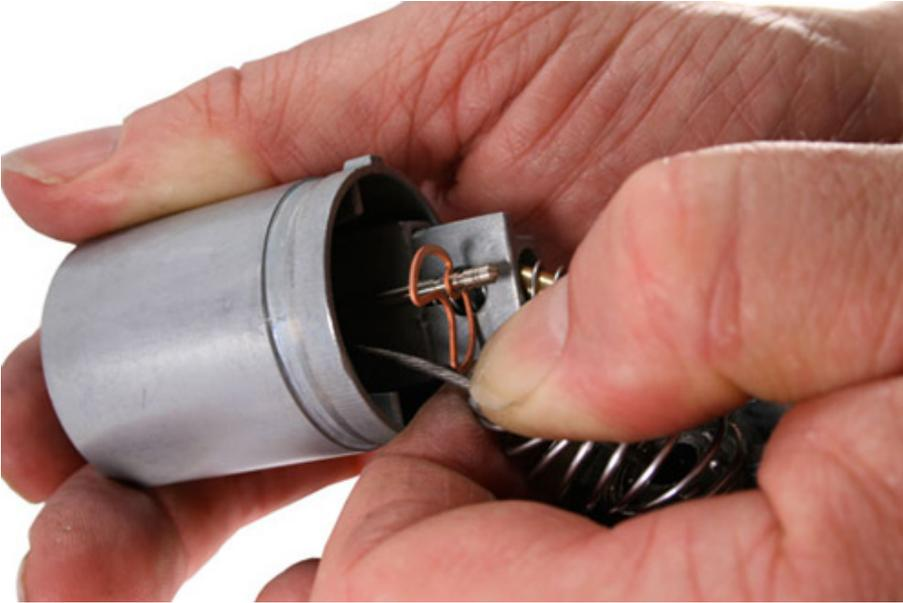
(e) Comprimer le ressort du volet d'air et décrocher le câble pour libérer le volet, le ressort et le tube en laiton.
