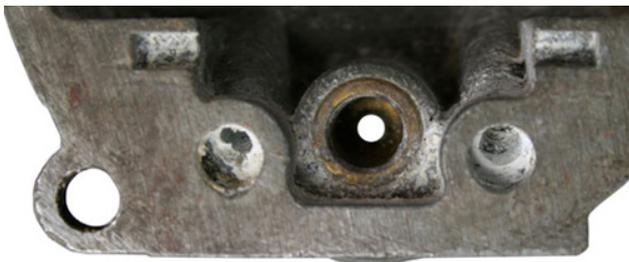
Nettoyer et inspecter le bouchon de vidange de la cuve, celui ci sert de point bas pour la cuve et récolte les impuretés. S'il présente des traces de dépôts durs il faut le remplacer. Les versions les plus anciennes du carburateur Mark 1 étaient dépourvues de bouchon de vidange. Ces carburateurs étaient équipés d'une chemise en tamis de laiton entourant le gicleur principal. Il est recommandé de remplacer ces cuves par de plus récentes.
