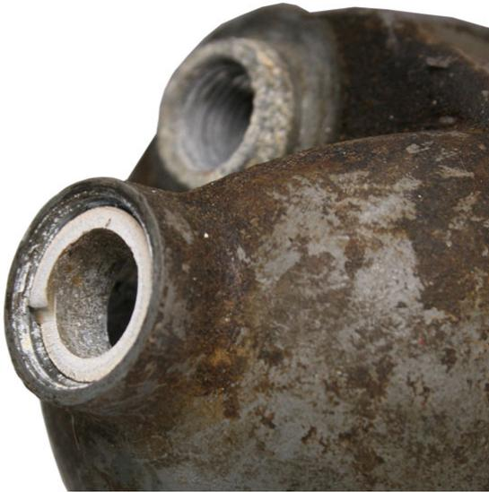
Le pointeau porte sur le siège en laiton. Si le siège présente des dommages, la cuve est à remplacer. Les premiers modèles du Concentrique étaient équipés de pointeaux en plastiques. Ils devraient être changés pour des pointeaux actuels à bout en Viton. Ces pointeaux à bout Viton sont beaucoup plus résistants à l'usure mais doivent être remplacés s'ils présentent des traces d'usure, ou autres dommages.
