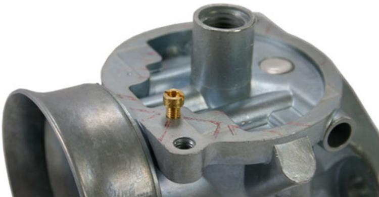
(d) Dévisser et retirer la vis d'air de ralenti. Si vous souhaitez retrouver le réglage au remontage vissez jusqu'au bout et notez le nombre de tours nécessaires pour y arriver avant de l'enlever.
