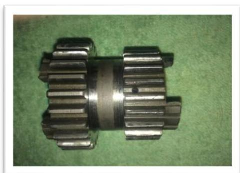
Même les trous pratiqués entre les dents du double pignon glissant de l'axe de transmission ont été faits de telle manière que jamais ils ne bouchent les trous de l'axe de transmission quand le pignon se bloque sur une vitesse par action du mécanisme sélecteur de vitesses et ils se superposent entre eux.
