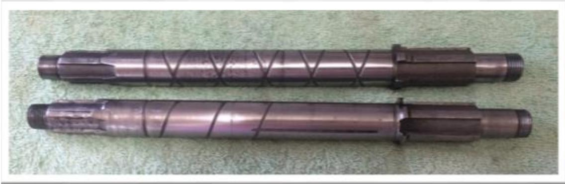
*Je prends note sur l'importance du feutre au bout de l'arbre de transmission, non seulement pour empêcher l'entrée de particules abrasives dans la boîte, mais aussi pour retenir dans la mesure du possible la perte de lubrifiant. De fait j'ai trouvé un petit joint spi avec simple lèvres OA-20X28X4-NBR - 20x28x4 mm qui se place à la perfection dans la cage de l'écrou du pignon de sortie de transmission secondaire.*
