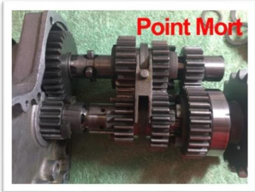
De fait, sans encore visser l'écrou du bout de l'arbre principal, nous allons sélectionner le point mort en tournant le bout carré du levier de l'opérateur du sélecteur qui sort du couvercle intermédiaire avec l'aide d'une clé anglaise et nous ferons tourner les deux arbres.
