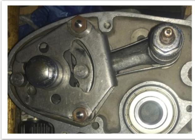
d'attention c'est la plaque de réglage FC41 qui permet une légère rotation et qui doit se caler bien centrée par rapport au levier de la pédale de vitesses FC1-35. Si tous les éléments sont en bon état cela suffit et il faut seulement régler pour compenser quelque autre usure de leurs éléments, tels que les dents du cliquet interne FC4-35 ou du cliquet externe FC1-35 ou la fourchette du même levier de pédale du sélecteur.
