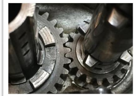
Le premier élément à régler, c'est la fine rondelle en forme de plat H4a de 0,3mm (ou son remplaçant), entre le roulement et l'engrenage fou 30 T de 1<sup>ère</sup> de l'arbre de transmission qui va nous aider à aligner avec sa paire le petit pignon 18 T H17 de l'arbre intermédiaire dont dents se positionneront face à face si tout va bien.
