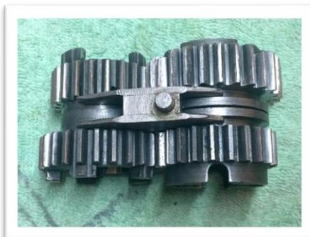
A cette étape, il faut monter le bras opérateur, l'axe de transmission avec le double engrenage glissant et l'engrenage 30T de 1<sup>ère</sup> avec sa rondelle d'écart, et l'axe intermédiaire avec sa douille rainurée et les engrenages de 2<sup>ème</sup> et de 3<sup>ème</sup> sans oublier la fourchette du sélecteur engagée entre les trois engrenages : le double glissant de l'axe de transmission et leurs appairages de l'arbre intermédiaire.
