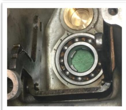
Le second élément de réglage c'est le positionnement latéral du bras opérateur de sélection. Cet élément bascule grâce à deux petites vis de pivot qui se vissent depuis l'extérieur. Le bras opérateur doit se déplacer sans le forcer sur tout son parcours le long de l'arbre de transmission et de l'arbre intermédiaire et leurs dents de retenue doivent s'aligner le plus droit possible sous le plunger de la vis de rétention.
