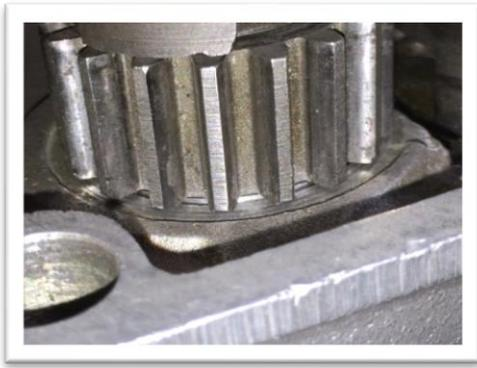
En seconde étape nous devrons faire le choix de déterminer si l'arbre principal a besoin d'une rondelle d'écart entre le trower oil et le roulement pour donner un peu plus d'espace entre les dents du pignon 18T et les parois internes du siège du roulement ainsi que pour l'aligner avec l'engrenage K.S. Sur la boîte des années 40 il y avait une fine rondelle de 0.10mm supplémentaire entre le roulement et le trower oil interne comme mesure de prévention.
