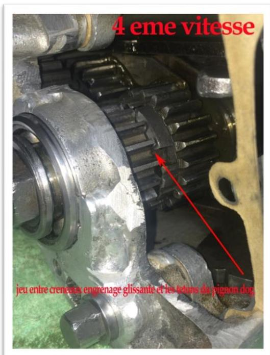
Si maintenant il y a un minimum jeu de 0,50mm entre les deux axes continuer le test, sinon, vérifiez que l'assemblage de l'arbre primaire soit l'original sans aucune modification ni pièce retouchée.
