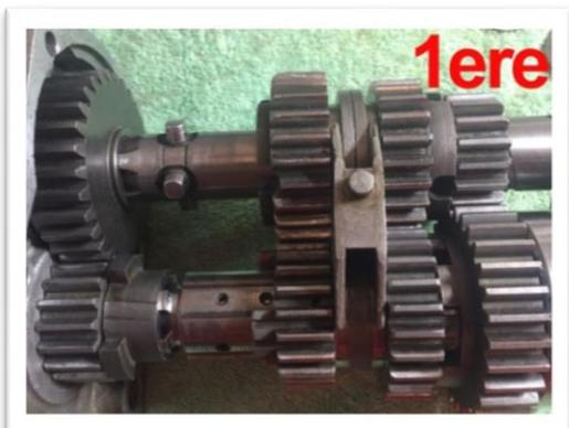
première vitesse pour fixer le bras opérateur sur sa position correspondant à cette vitesse. Après, pour vérifier, nous ferons tourner un petit poil à droite (horaire), le levier de sélection sans arriver à sélectionner le positionnement du point mort, avec telle procédure que nous pourrions avoir une rotation de l'arbre un petit peu plus douce ou aucun changement de résistance à tourner de l'arbre par rapport au positionnement de première vitesse du bras opérateur.
