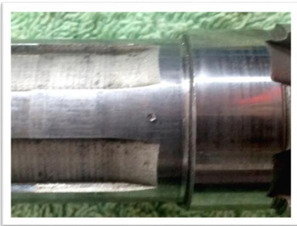
La seule solution que j'ai trouvée dans le cas de n'avoir qu'une rondelle plat, c'est de donner une petite résistance au glissement de l'arbre de transmission dans son roulement, en le marquant de 5 points (un pour chaque rainure), avec l'aide d'un burin pointu en acier pour l'immobiliser et de cette manière réussir, dans un futur, changer ou faire sortir le pignon de sortie de transmission primaire en évitant de devoir tout démonter pour faire revenir la rondelle à sa place.
