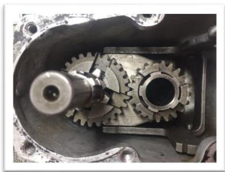
On y va placer maintenant l'opérateur inséré dans les deux petits axes de pivot des vis de fixation, encore libres et sans les emprisonner dans leurs sièges respectifs extérieurs du boîtier. La fourchette assemblée avec les engrenages de 2<sup>onde</sup> , 3<sup>eme</sup> de l'arbre intermédiaire et l'engrenage double glissant de l'arbre de transmission, puis insérer l'ensemble dans les deux arbres, et les tétons de la fourchette dans les bras de l'opérateur.
