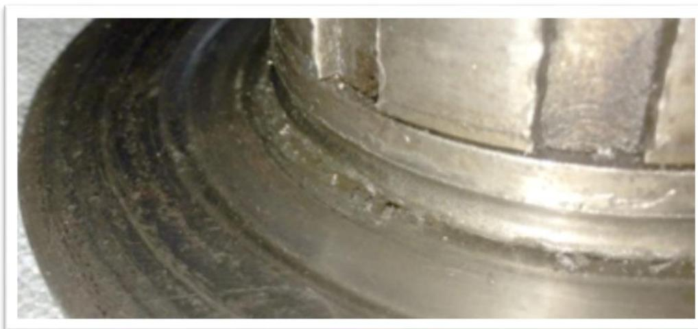
*Je prends note:* après d'avoir vu sur mon vieux embrayage les dégâts des billes sur la piste de roulement du centre d'embrayage il vaut mieux ne pas débrayer plus du temps nécessaire lorsque cela n' est pas strictement impératif.
