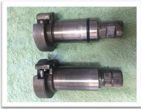
Le bout de l'axe du mécanisme K.S. ainsi que le levier de démarrage sont rainurés pour les modèles des années 40 au lieu d'une fente sur le bout de l'axe qui sert pour introduire une vis de butée G43 avec un angle de cale qui bloque le kick en traversant son siège. Ils sont interchangeables entre les deux designs, mais avec leurs pédales de démarrage respectives.
