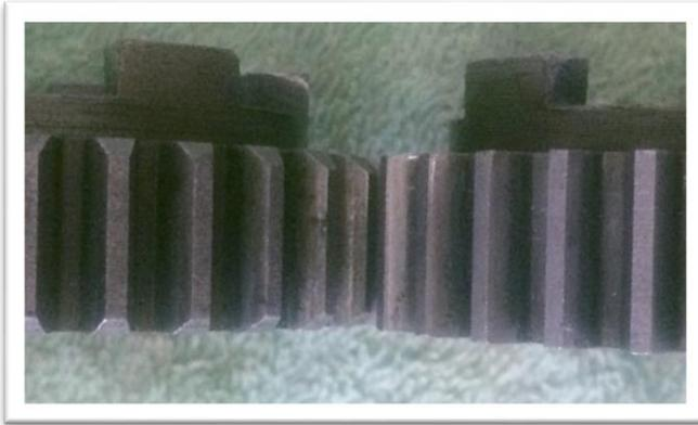
Les boîtes des années 30 ont des engrenages avec un profil droit des dents, alors que les dents des engrenages des boîtes des années 40 sont biseautées. Les deux types d'engrenages sont compatibles mais il faut préférentiellement les monter par couples d'engrenages sur l'axe de transmission avec ses correspondants sur l'axe intermédiaire.
