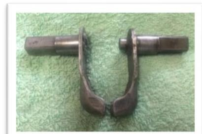
Le levier du sélecteur de vitesses FC47 porte un téton de butée dans son bout intérieur qui pousse contre une base plate qui se place à l'intérieur de l'oreille du boîtier. Ce téton n'est pas sur le levier des années 30, mais les deux sont interchangeables et dans les deux cas peu importe quel que soit le choix, le téton ne sert que d'aide pour refermer la boîte.
