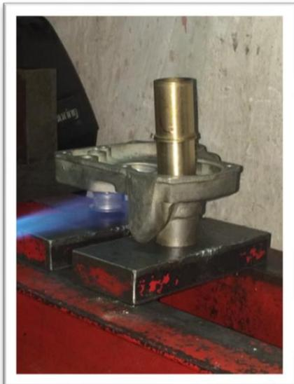
Que son bout de sortie s'aligne dans le même plan que le rebord du corps extérieur du couvercle extérieur où elle est enfoncée.
