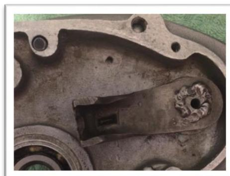
A la livraison Albion n'a pas prévue dans les années 30 la ventilation de la boîte, qui n'était pas nécessaire car les roulements étaient ouverts et l'étanchéité était réalisée au moyen de feutres et des trower oil. Mais maintenant que nous avons mis des roulements 2RS et/ou ZZ, un joint spi à la sortie de l'arbre de transmission et un « O » ring sur l'axe du kick, s'imposé.
