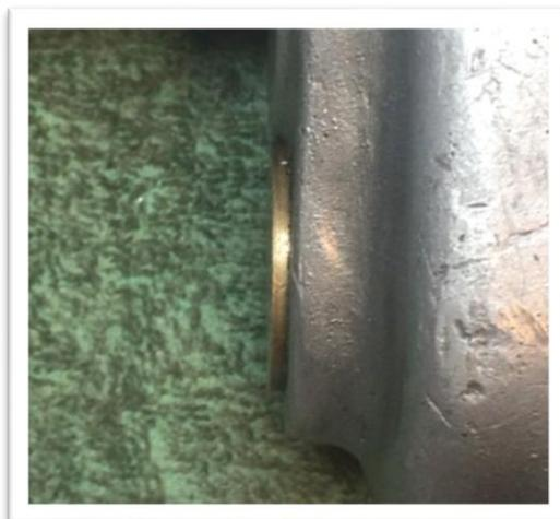
Avec l'aide d'une presse hydraulique et après avoir bien chauffé la zone elle sera portée au sommet qui marque sa lèvre, et son culot sortira un peu à l'extérieur de la boîte. Il faut l'introduire au bout pour ne déplacer vers le haut, plus que ce qu'il ne se doit, l'arbre intermédiaire. Il est recommandé de procurer un espace sous le boîtier afin que la bague aveugle puisse déborder un peu.
