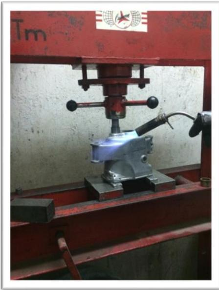
A chacun sa méthode, il y a ceux qui se débrouillent avec leur savoir, ceux-ci qui demandent de l'aide, comme moi qui a fait appel à un bon ami avec une lampe à gaz et une presse hydraulique sans laquelle je n'aurai pas pu extraire et puis assembler les bagues en bronze et la douille en acier du mécanisme sélecteur.
