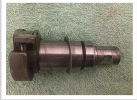
Aussi j'en ai profité pour modifier l'axe de démarrage pour faire une gorge pour y loger un « O » ring et une autre plus petite juste au-dessous du rebord où se loge le capuchon de rétention du ressort de retour afin de loger un circlip de rétention pour l'immobiliser.
