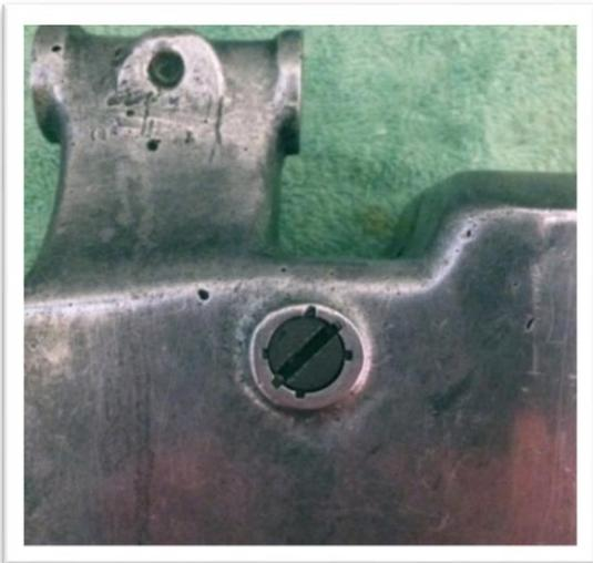
Pour les deux vis de pivot du bras opérateur il faut fraiser avant les deux chanfreins de blocage du rebord avec l'aide d'une Dremel et après on doit réchauffer un peu pour ramollir la pâte de fixation avant les dévisser.
