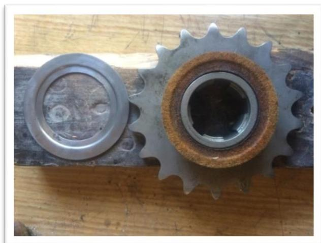
Mais si le pignon neuf est à congé long, avant d'assembler le roulement il faut remplacer le feutre pour celui de la version des années 40 avec un diamètre interne plus petit prévu pour monter un pignon de transmission à congé long afin d'éviter que la boue extérieure entre en contact direct avec le roulement.
