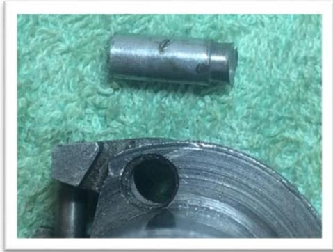
Il ne reste que vérifier l'état de la gâchette du cliquet du mécanisme K.S. et de son axe. J'ai dû refaire l'axe, qui était très endommagée, à partir d'une visse en acier d'assemblage d'une armoire IKEA, que curieusement a le même diamètre. Son but plus étroit a une concavité centrale pour aplatir son rebord.
