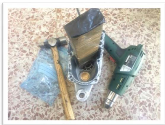
Au cas où vous avez monté la bague aveugle avant, faites attention avant de pousser le roulement de procurer un espace sous le boîtier afin que le culot de la bague aveugle ne rentre pas avec les coups de marteau.
