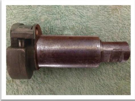
La vieille bague H27 n'entrait pas dans le nouveau couvercle, son diamètre extérieur était un petit plus grand. La bague du nouveau couvercle ne s'adaptait pas à l'axe du kick dont diamètre était plus petit que le diamètre interne de la bague. C'est une chose normale, la vieille bague était fait sur mesure du vieux couvercle dont support étendu de la bague en bronze du kick avait cassé et j'ai donc dû réaléser son diamètre extérieur pour la monter sur le neuf couvercle intermédiaire.
