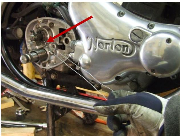
Remettre en place le couvercle de boîte, l'arbre de kick positionné de façon à ce que le rocher de kick soit comprimé.
