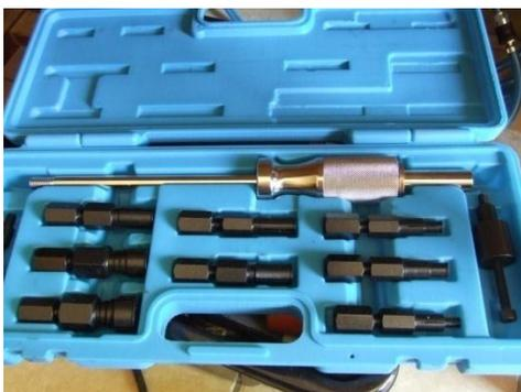
Un coffret d'extracteurs de roulements, avec système à inertie, prêté par un copain. Probablement efficace si le roulement est encore entier !
