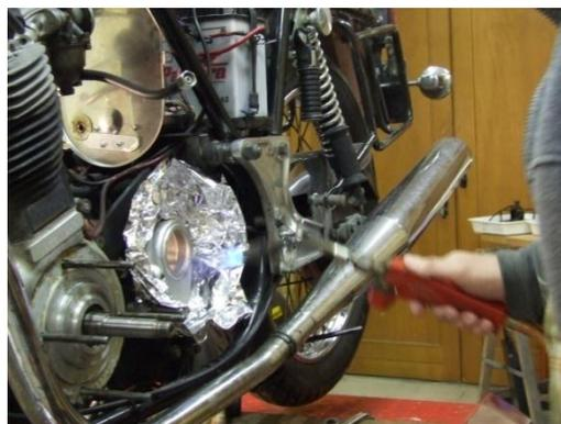
Et là, c'est beaucoup plus dur. J'ai ressorti le roulement de l'arbre et je l'ai enquillé en tapotant avec une grosse douille, de la dimension de la bague extérieure. Pas à pas, et en surveillant bien que le roulement ne rentre pas de travers...
