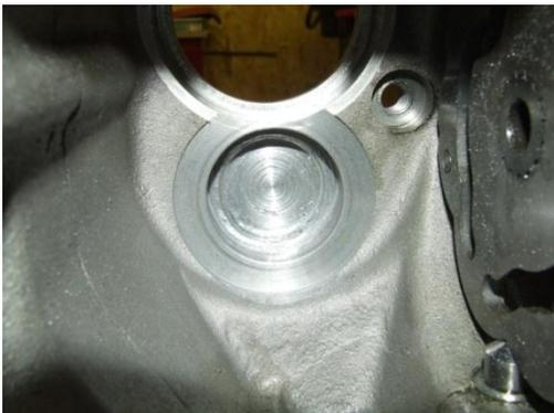
J'ai rectifié la face d'appui avec un outil genre « Dremmel » et une meule fine cône pour meuler le fond sans toucher la portée radiale du roulement. Le résultat est satisfaisant...
