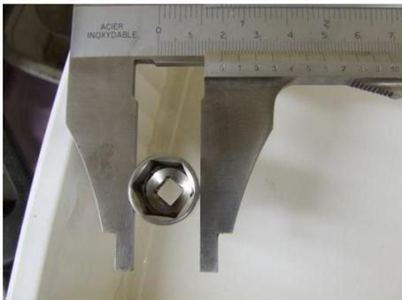
Une douille de 17/32", avec un  $\varnothing$  extérieur maxi de 19mm. La cote sur pan des écrous est 13,49 mm
