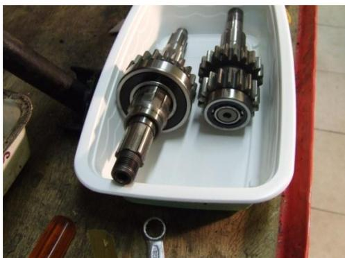
Les roulements sont remontés sur les arbres, prêts à être insérés dans leur logement.
