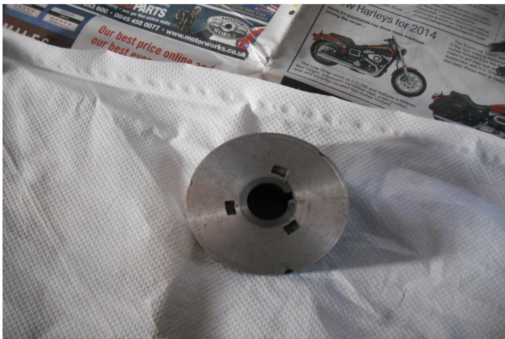
Après un montage a blanc de la poulie moteur et du rotor il s'avère que l'entretoise d'origine n'est pas assez épaisse, ce qui oblige au rajout d'une rondelle pour avoir une meilleure accroche de la clavette la rondelle est limée pour laisser un passage
