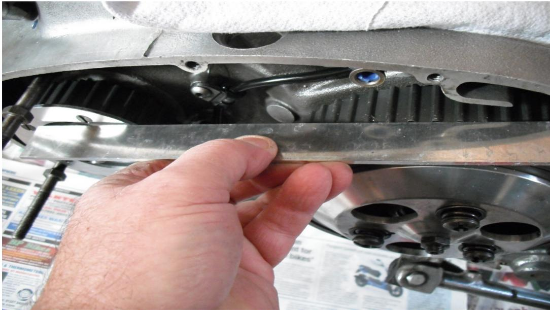
Après contrôle il y a 2.5mm à rattraper sur la poulie moteur, une rondelle de calage de la même valeur prend donc place entre le roulement et la poulie,
