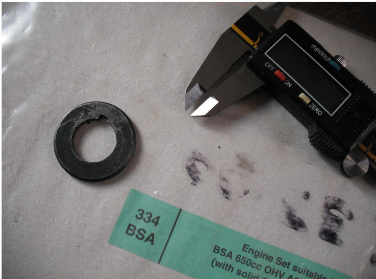
Pour une augmenter la portée de l'axe moteur dans le rotor une bague usinée dans du laiton est emmanchée dans le goujon
