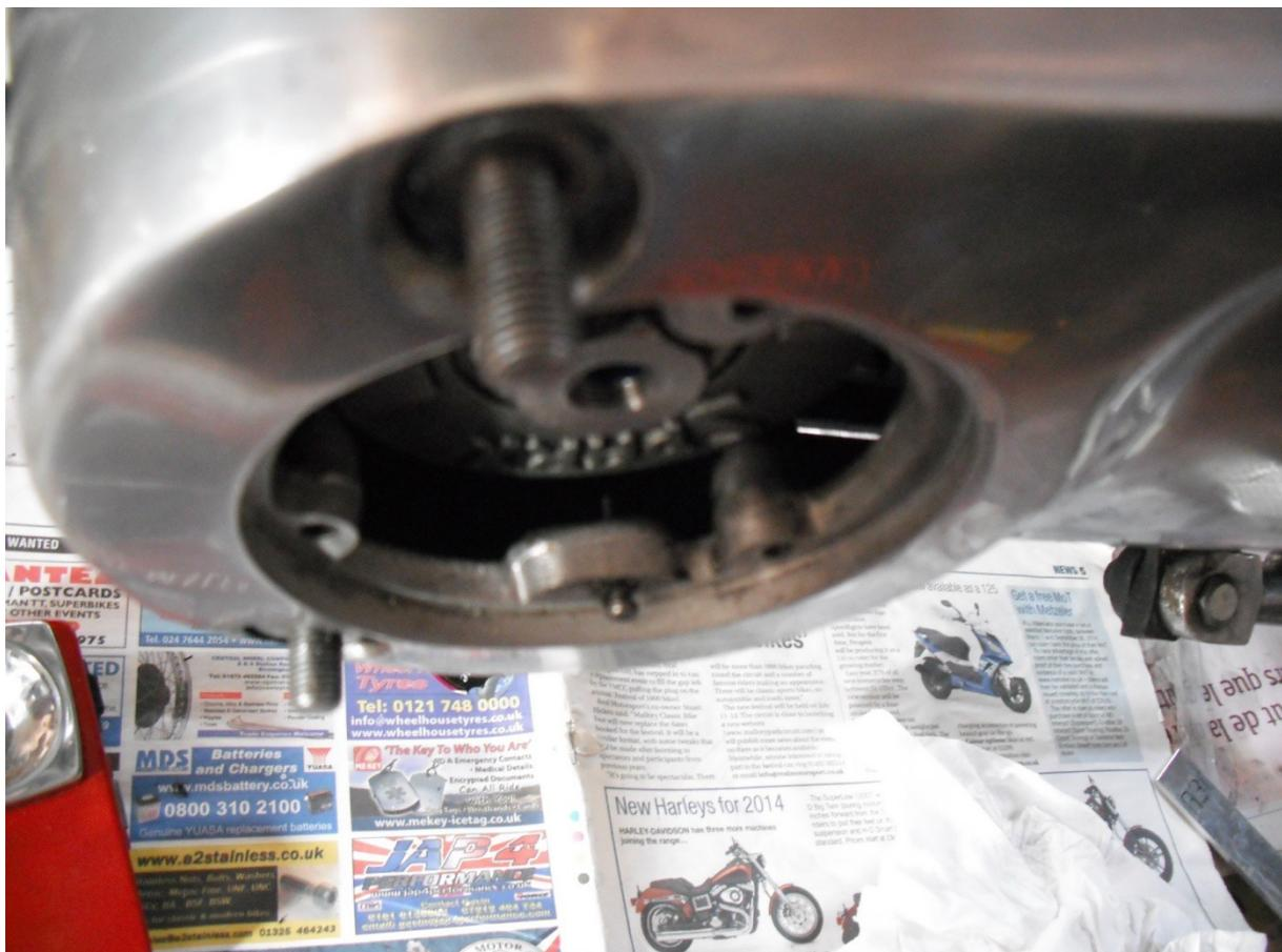
Sur le Triton de mon fils j'avais supprimé ces bossages, mis des vis a tête fraisée et des écrous a l'extérieur, ce n'est pas une bonne solution même un peu facile et l'utilisation de cette trappe pour le calage a la lampe strobo devient difficile
